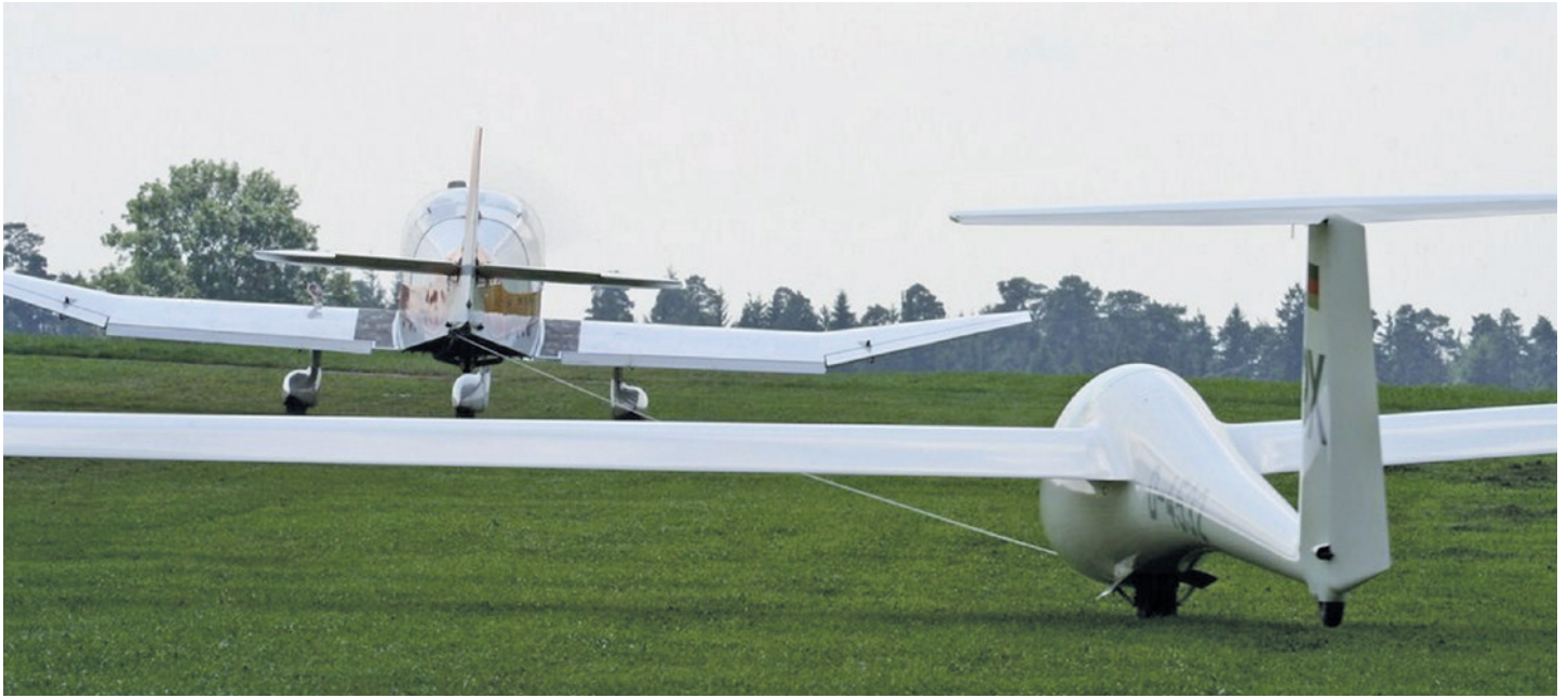
Start eines Segelflugzeugs per Flugzeugschlepp. Foto: DAeC
